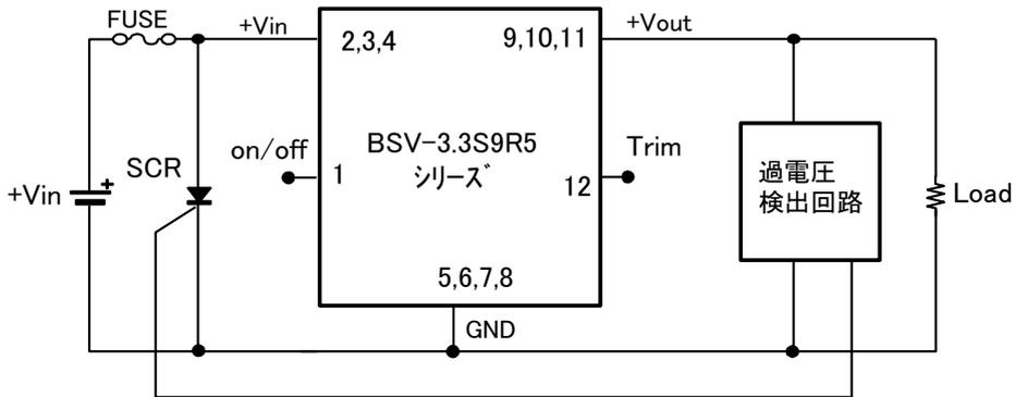
注1. 過電圧モードで破損の場合には ON/OFF 制御は動作いたしません。
